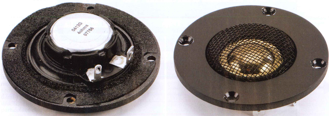
Il tweeter utilizza una cupola da 19 millimetri realizzata in puro titanio. Notale la ghiera di protezione e le dimensioni del complesso magnetico.
