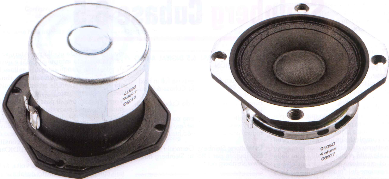
Il piccolo midrange utilizza una membrana di cellulosa ed una sospensione abbastanza rigida. Il complesso magnetico, come per il woofer, è schermato.
